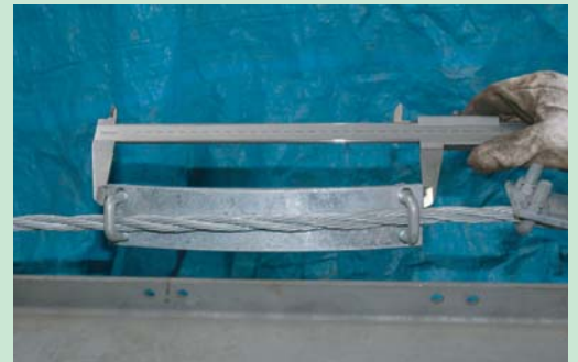
1.0 t 負荷時のテンションバー 約12mm伸びています。
