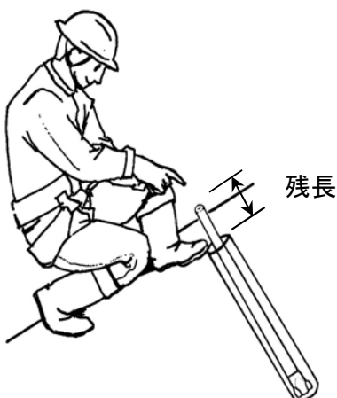
4. 削孔完了 (残尺検測)
